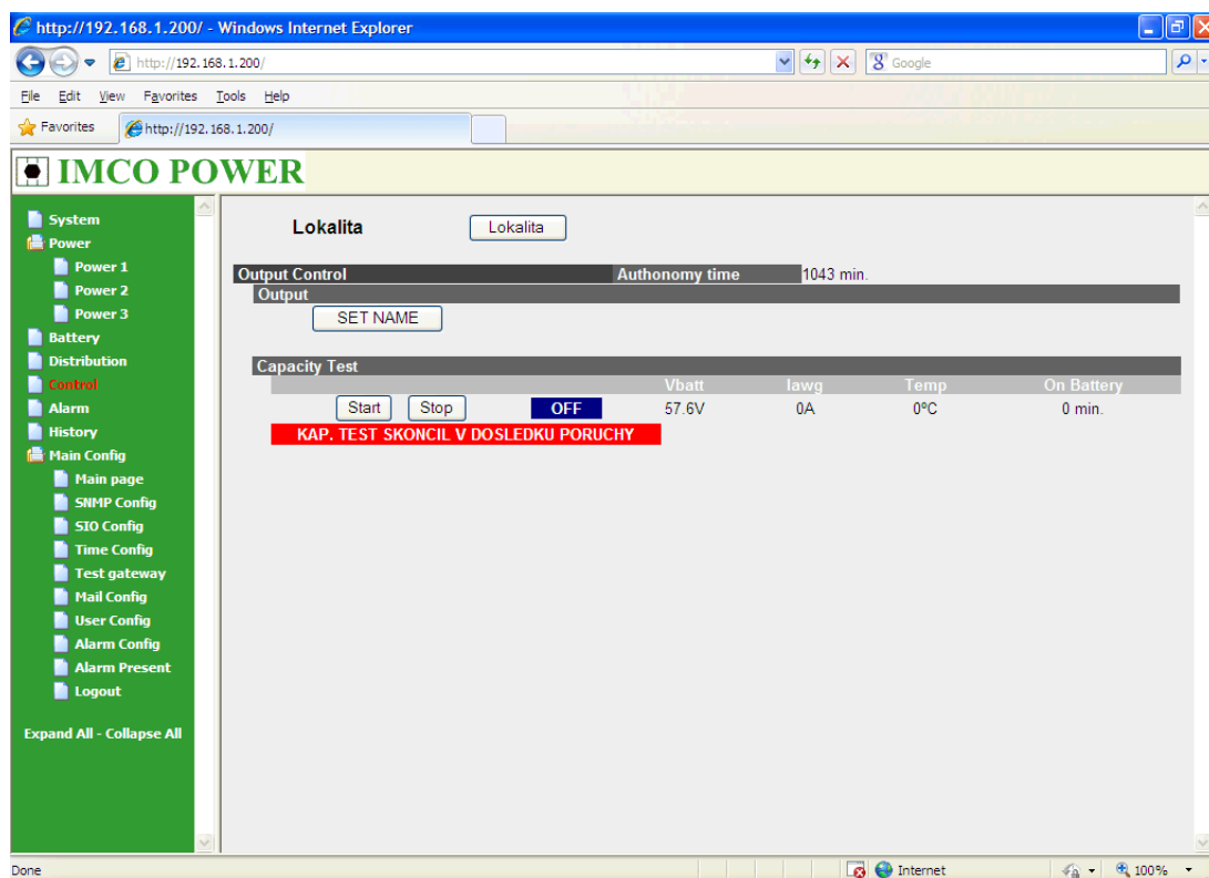
Obr. 7.5 – ukončenie kapacitného testu akumulátorov v dôsledku poruchy
